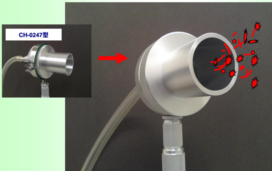
このサンプリングホルダは“アスベストモニタリングマニュアル (第4.0版)”や“JIS K3850-1 空気中の繊維状粒子測定方法”の仕様に準拠しています。また、作業環境測定の際のろ過捕集用のオープンフェイスホルダとしてもご利用いただけます。
